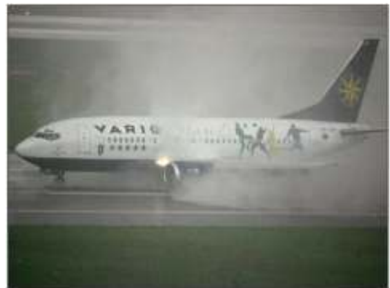
Figura 7 - O freio motor chamado reverso acionado no pouso (Foto cedida por um Comandante da FAB).
