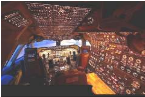
Figura 1 - Antigo posto do terceiro homem na cabine de controle (cockpit).
