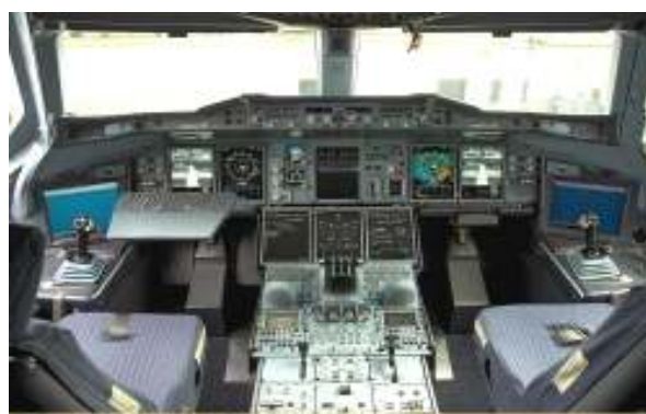
Figura 9 - O cockpit do Airbus A-380 - Glass and Paperless cockpit além dos “Stics” de comando (Foto disponibilizada pelo site America Aviation- www.americaviation.net ).
