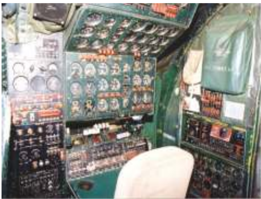
Figura 2 - Posto de trabalho extinto do engenheiro de voo.
